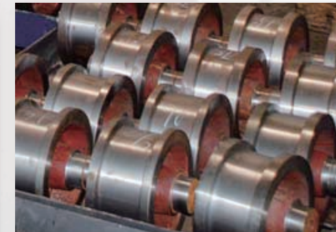
Casting wheel DIN GGG70
